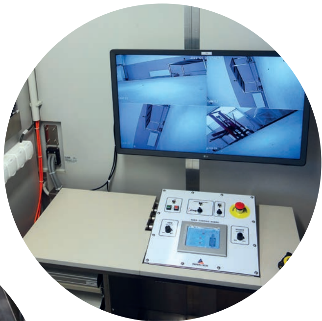
Auf einem HD-Bildschirm sieht der Operator jede Bewegung des Roboters in Echtzeit
